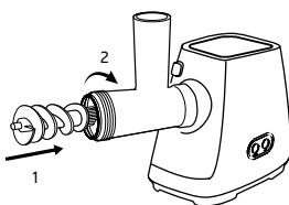
3. Наденьте нож на посадочное место на шнеке режущей стороной наружу. Если установить нож режущей стороной внутрь, продукты не будут измельчаться. Поверх ножа наденьте перфорированный диск (для правильной установки диска совместите паз на кромке диска с выступом на внутренней стороне блока мясорубки). Закрепите нож и диск на блоке мясорубки с помощью фиксирующего кольца, поворачивая его по часовой стрелке.
