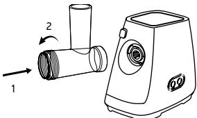
2. Вставьте шнек в блок мясорубки и поверните его по часовой стрелке для фиксации в корпусе.
