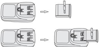
Подключите зарядное устройство к сети переменного напряжения 220В (50/60Гц). USB порты, отмеченные 2,4A, предназначены для устройств, требующих для зарядки большого уровня тока (например, Ipad). USB порты, отмеченные 1A, предназначены для устройств, требующих для зарядки стандартного уровня тока.
