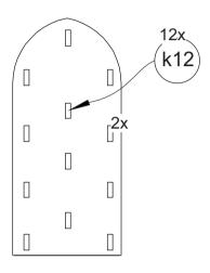
Поверхности склеивания зеркала и двери протрите и обезжирьте. Уложите подзеркальник с зеркалом на некоторое время в горизонтальное положение, для лучшего приклеивания.
