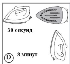
Үтікті автоматты сөндіру функциясы келесідей тәсілмен жүзеге асады: Белгілі бір температурага дейін қыздырылған, бірақ, қолданылмаған үтік, сондай-ақ, табанында жатқан немесе бір қырынан жатқан үтік 30 секундтан кейін автоматты түрде сөнеді. Егер үтік пайдаланылмаса және таяныштірекti тігінен тұрса, - автоматты түрде сөну режимі 8 минуттан кейін қосылады (D сурет).
