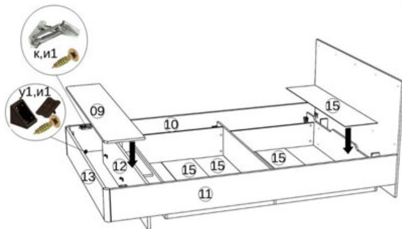
**Шаг 4:** К царгам 10, 11, к опоре и спинке ножной 12, 13 прикрутить уголки командор (у) шурупом 4х16 (и1). К царгам 10, 11 прикрутить кронштейн антресольный с пружиной (к) шурупом 4х16 (и1). Установить донышки ящиков 09, 15.
