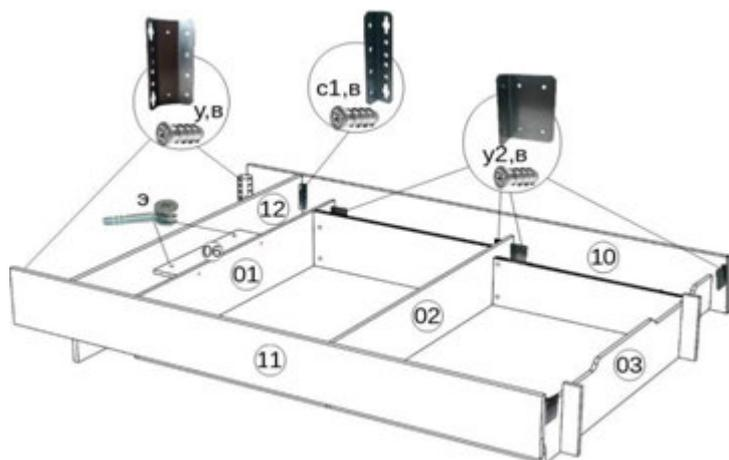
**Шаг 2:** К брусу стягивающему 06 прикрутить опору ножную 12 при помощи эксц. стяжки (э). К царгам 10, 11 прикрутить уголки (у2), уголок трапецию (у) стяжку кроватную (с1) винтом М6х13 (в). Установить втулку D8 (в2). Соединить царги с бельевым ящиком с помощью винта М6х13 (в).
