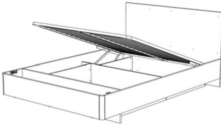
**Шаг 6:** Собрать кроватьное основание (согласно инструкции КРУ11). Установить основание на механизм подъема, закрепить при помощи винта, шайбы и гайки (согласно инструкции МП15). Установить **газ-лифты** штоком **вниз!!!**
