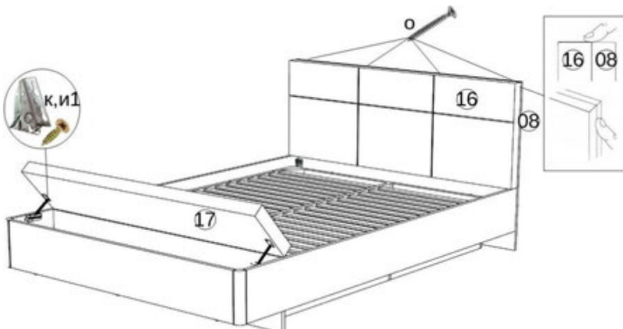
**Шаг 7:** К спинке головной **08** прикрутить шурупом 3,5x30 (о) накладку (мягкий элемент) **16**. Прикрутить мягкий элемент банкетки **17** шурупом 4x16 (и1). Уложить матрас.
