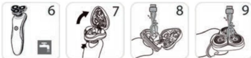
в корпус электробритвы. После полного высыхания закройте бреющий блок, наденьте на него защитный колпачок и уберите бритву на хранение.
