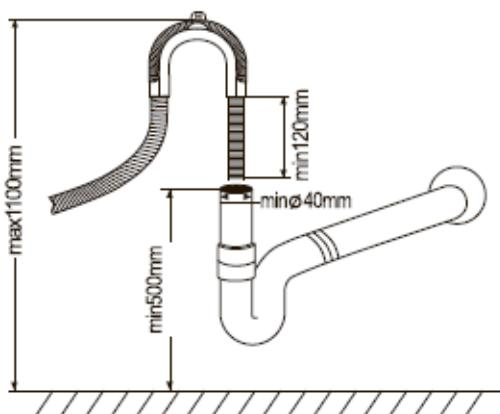
Подсоедините сливной шланг от устройства к канализационной трубе так, чтобы не допустить его изгибов.
