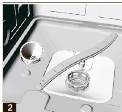
A. Извлеките нижнюю корзину, после чего открутите и снимите крышку с отделения для регенерирующей соли. **1**
