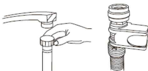
Подсоедините заливной шланг к резьбовому соединителю 3/4 (дюйма) и убедитесь в его надежной фиксации.
