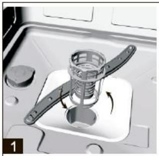
Шаг 1: поверните фильтр грубой очистки против часовой стрелки, после чего поднимите его вверх.
