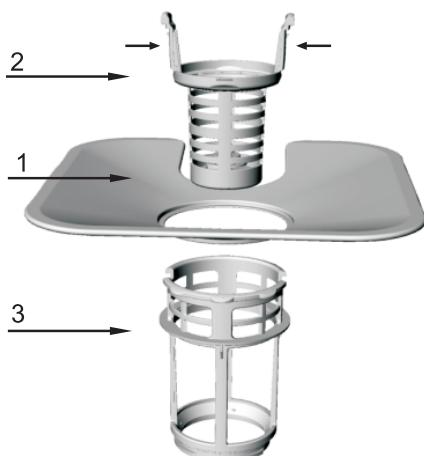
Система фильтрации состоит из фильтра грубой очистки, плоского (основного фильтра) и микрофильтра (фильтра тонкой очистки).
