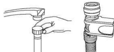
Підключіть шланг подавання холодної води до різьбового 3/4 (дюймового) патрубка та міцно закріпіть його. Якщо водопровідні труби нові або не використовувалися протягом тривалого періоду часу, нехай вода стече, щоб вона була чиста та без домішок. Якщо цього не зробити, є ризик блокування подавання води та пошкодження приладу.
