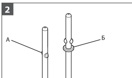
Прибор поставляется с двумя венчиками. Один без зажимной гайки (А) и один с зажимной гайкой (Б).
