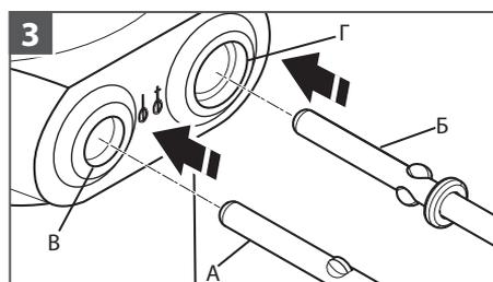
Вставьте венчик без зажимной гайки (А) в маленькое отверстие (В), а венчик с зажимной гайкой (Б) — в большее отверстие (Г). Выровняйте их положение и задвиньте до фиксации. Оба венчика защелкнутся на месте.
