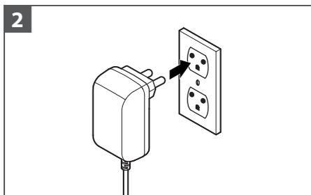
2 Подключите адаптер зарядного устройства к заземленной электрической розетке.
