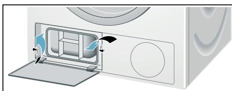
4. Снимите верхнюю крышку теплообменника.
