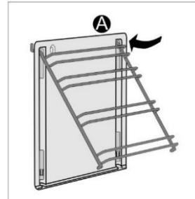
Наденьте вкладыш на направляющие: вставьте прутья направляющих в отверстия в верхней части вкладышей "A".
