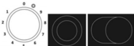
Вы можете изменить размер зоны нагрева конфорки в зависимости от диаметра и формы посуды. Для включения внешнего контура нагрева поверните переключатель конфорки до конца (слышен щелчок). Затем установите переключатель на необходимую степень нагрева.
