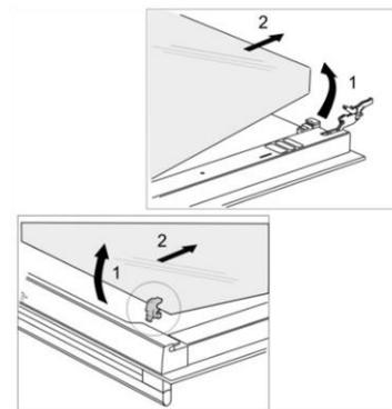
Возьмите стекло дверцы за нижний край, немного приподнимите, чтобы оно освободилось из фиксаторов, и снимите.
