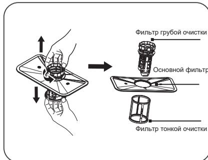
Система фильтрации состоит из фильтра грубой очистки, основного фильтра и микрофильтра (фильтра тонкой очистки).
