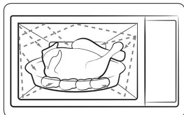
1. Микроволны, генерируемые магнетроном, отражаются стенками внутренней камеры печи и равномерно распределяются в пище, когда она вращается на подносе. За счет этого пища готовится равномерно.
