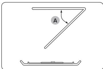
Щоб почистити верхню частину камери, опустіть верхній нагрівальний елемент на 45° (A), як показано на малюнку. Так чистити верхню частину камери буде зручніше. Після завершення чищення встановіть верхній нагрівальний елемент на місце.
